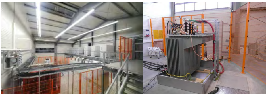
Abbildung 12: Blick in das Prüflabor Netzintegration (links) und Test des entwickelten regelbaren Ortsnetztransformators der J. Schneider Elektrotechnik GmbH aus dem Projekt „Aktives, intelligentes Niederspannungsnetz“ (rechts) in der SysTec
